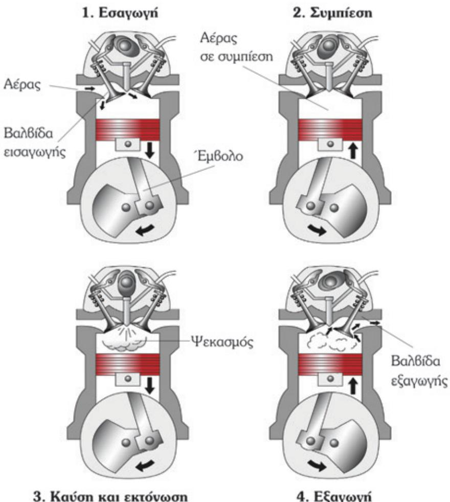
**Σχήμα 2.9.** Κύκλος λειπουργίας τετράχρονου πετρελαιοκινητήρα
