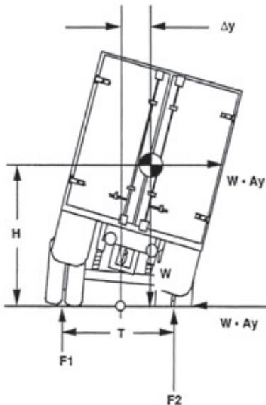
**Σχήμα 4.2.** Σχηματική αναπαράσταση βαρέος οχήματος σε σταθερή στροφή
