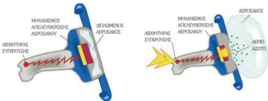
Σχήμα 4.1. Λειτουργία αερόσακου.
